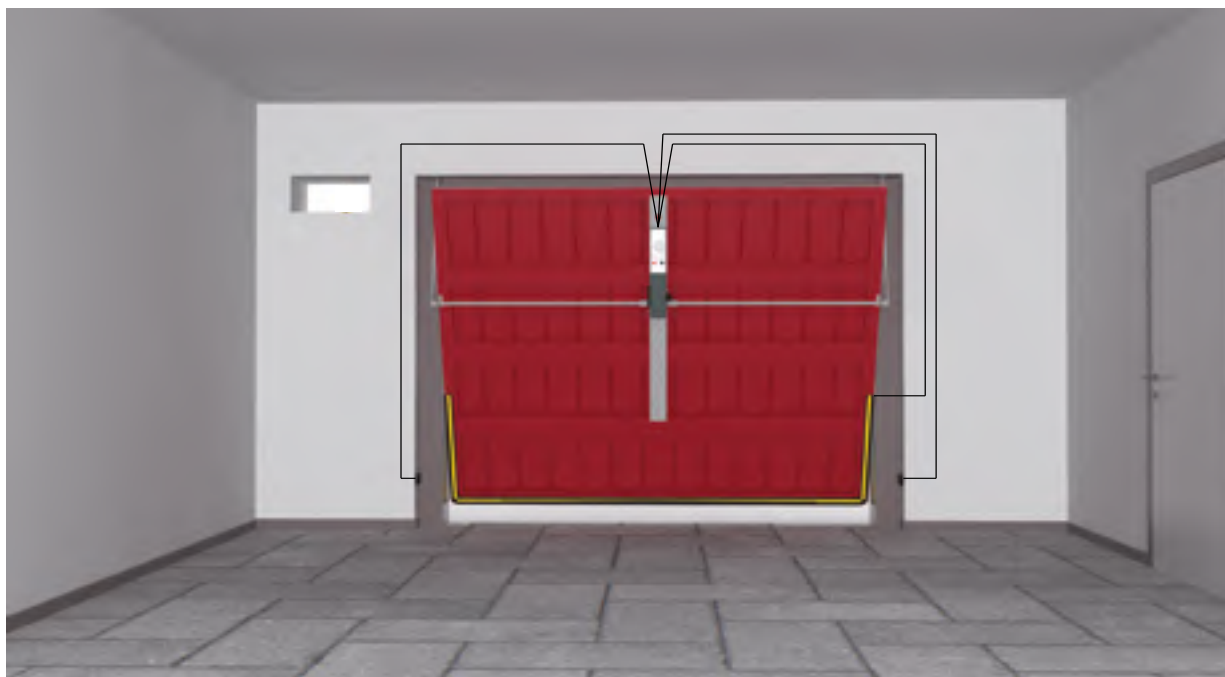
IMPIANTO TIPO CON MONTAGGIO CENTRALE
