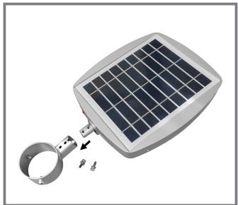
2. Inserire la staffa di supporto e fissarla con le viti a brugola.
